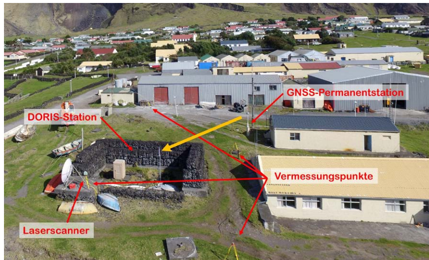
Abb. 4: Vermessungsarbeiten im Bereich der GNSS- und DORIS-Stationen. Der orangefarbene Vektor zeigt die Verbindung GNSS – DORIS-Antenne.
