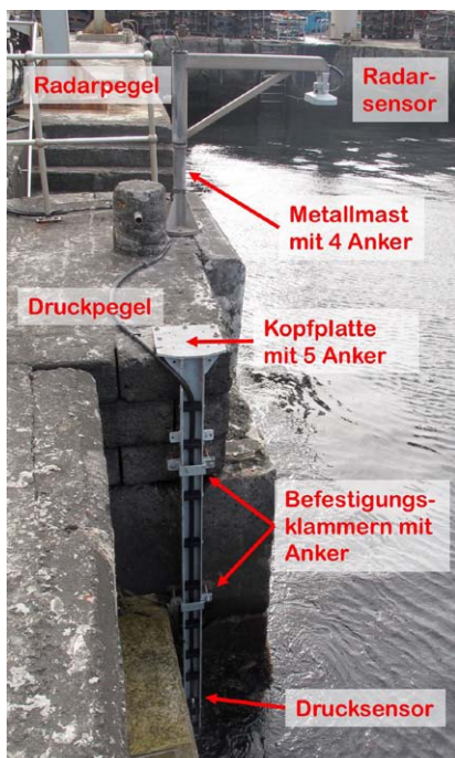
Abb. 3: Druck- und Radarpegelinstallationen im Hafen bei Ebbe
