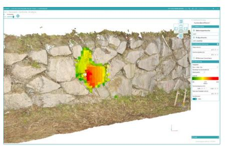
Die Laserscan-Messmethode kann zur Detektion von Änderungen bzw. Bewegungen bei Wänden, Stützmauern, Steinmauern und anderen Strukturen herangezogen werden.
