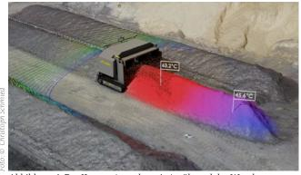
Abbildung 4: Der Kompostwender misst während des Wendevorgangs die Temperatur der Kompostmiete mit und schickt die gemessenen Werte in ein Datenmanagementsystem.
