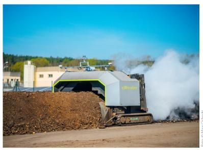
Abbildung 2: Der autonome Kompostwender ist mit zahlreicher Sensorik ausgestattet. Die beiden GNSS-Antennen und der GNSS-Empfänger, die inertiale Messeinheit und die Inkrementalgeber der Ketten werden zur hochgenauen Positionierung verwendet. Mithilfe des LiDARs nimmt der Kompostwender seine Umgebung wahr.
