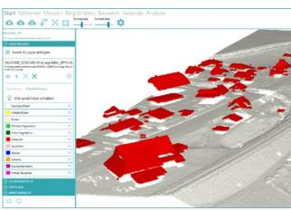
Mit nur einem Klick kann die 3D-Darstellung der Punktwolke mit der Version 2023.2 auf Basis der Klassen eingefärbt werden.
