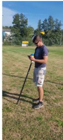
Neigungskompensiertes Erfassen und Abstecken in rmDATA Mobile Collector.
