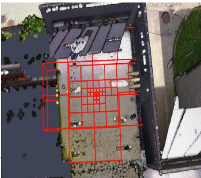
Abbildung 2: Der Octree zerlegt die Welt in mehr (Mitte) und weniger (Rand) detaillierte Bereiche
