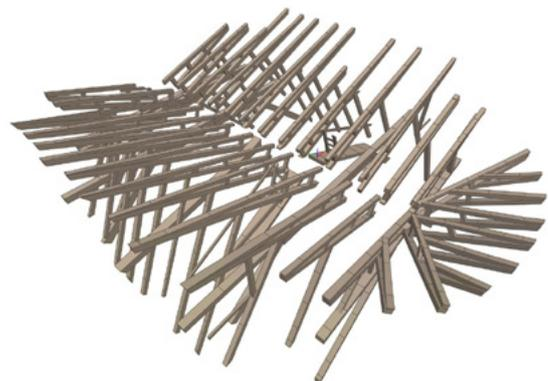
Die 3D-Modellierung von Stehern und Balken bei komplexen Dachstühlen war in einem Projekt ein wichtiges Feature in 3DWorx. Oben: Bereinigte Punktwolke (höhenkodiert), unten: 3D-Modell (BIM)
